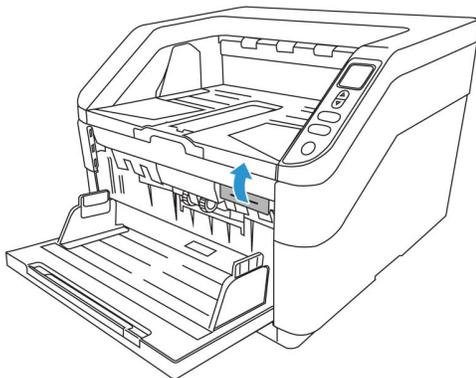
Dopo aver sostituito i rulli, chiudere con cura lo scanner premendo entrambi i lati del coperchio verso il basso finché non risulta bloccato in posizione. Non chiudere con forza il coperchio.
