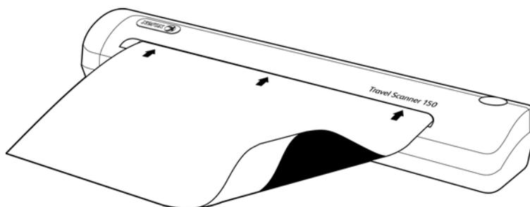
6. La pagina di calibrazione viene prelevata dallo scanner e viene spostata in avanti e indietro durante la calibrazione.
