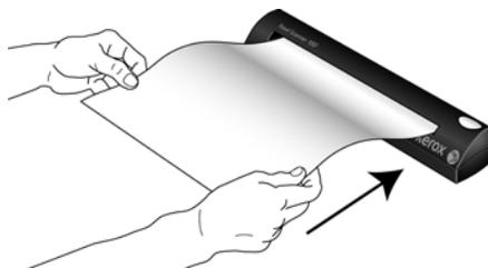
Der Scanner greift die Oberkante der Vorlage und beginnt automatisch zu scannen und die Vorlage durch den Scanner zu ziehen.
