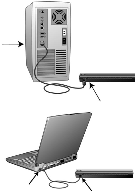
Wenn der Stecker nicht ohne Widerstand eingesteckt werden kann, vergewissern Sie sich, dass Sie ihn korrekt und in den richtigen Anschluss stecken. Drücken Sie den Stecker nicht gewaltsam in den Anschluss.
