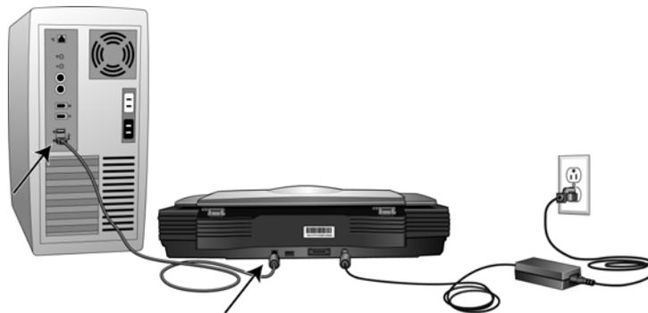
4. Accendere lo scanner. Nella figura riportata di seguito è indicata la posizione dell'interruttore di alimentazione dello scanner.
