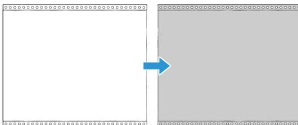
Legen Sie keinen Stapel mit zusammenhängenden Blättern in das Vorlagenfach. Das Papier reißt, wenn die Trennwalze versucht, die aktuelle Seite vom restlichen Stapel zu trennen. Wenn Sie ein langes Dokument auf Endlos-Druckerpapier scannen möchten, legen Sie den Vorlagenstapel hinter das Vorlagenfach auf den Tisch. Schließen Sie die Erweiterung des Vorlagenfachs, und legen Sie die führende Seite in das Vorlagenfach.
