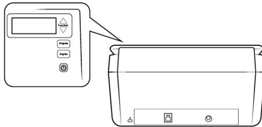
Die Statusleuchte blinkt. Damit wird angezeigt, dass der Scanner mit Strom versorgt wird.
