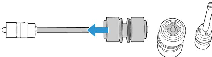
9. Setzen Sie das runde Ende der Walze in die Aussparung im Scanner ein. Führen Sie die Walze vorsichtig in den Scanner ein. Vergewissern Sie sich, dass die Rille rechts an der Aufhängung so ausgerichtet ist, dass sie in die U-Form der Klammer passt.
