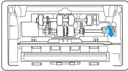
5. Winkeln Sie die Walze nach oben an, und entnehmen Sie sie aus dem Scanner. Entsorgen Sie sie dann, da sie nicht repariert werden kann.
