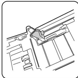
4. Die untere Walze ist mit einem Sicherungsriegel gesichert, der zum Verriegeln und Entriegeln gedreht werden kann. Drehen Sie den Sicherungsriegel zum Entriegeln so lange, bis der kleine Sicherungsflansch vollständig frei liegt.
