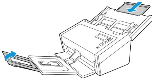
3. Heben Sie das Ausgabefach an, und klappen Sie es in Richtung Scanner ein. Drücken Sie das Ausgabefach weiter, bis es einrastet.
