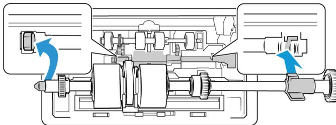
8. Drehen Sie den Sicherungsriegel in den Schlitz im Scanner. Drücken Sie den Hebel, bis er einrastet und die Walze im Scanner verriegelt.
