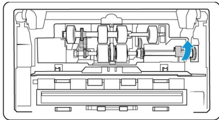
9. Heben Sie den Walzendeckel, und drücken Sie ihn vorsichtig zu. Vergewissern Sie sich, dass alles richtig ausgerichtet und der Deckel vollständig geschlossen ist. Wenn der Deckel nicht vollständig geschlossen ist, wird er beim Scannen brechen und den Scanner beschädigen.
