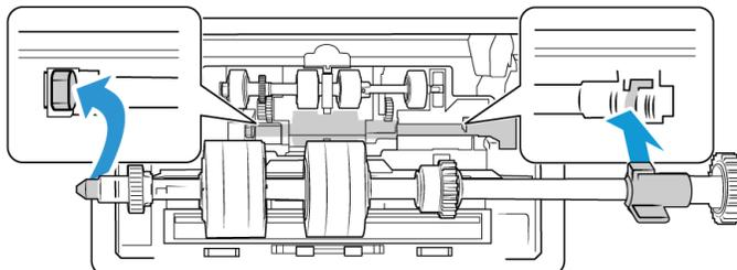
9. Gire a aba de travamento no slot do scanner. Pressione a alavanca até encaixar no lugar e travar o rolamento na porta do scanner.
