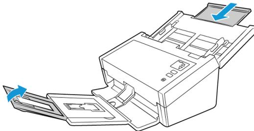
3. Levante a bandeja de saída e dobre-a contra o scanner. Pressione a bandeja de saída até a posição de encaixe.
