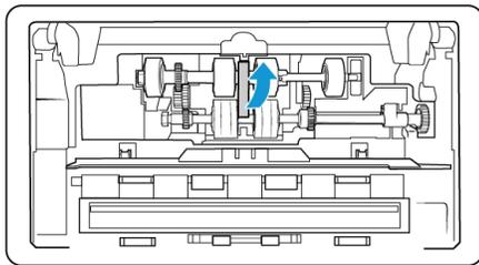
5. O rolamento inferior é mantido no lugar com uma aba de travamento que gira para travar e destravar. Para destravar a aba, gire-a até que o aro de travamento pequeno esteja completamente solto.
