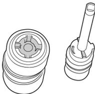
9. Insira a extremidade arredondada do rolamento no slot do scanner. Insira o rolamento no scanner. Certifique-se de que a ranhura do lado direito da barra esteja alinhada, para que ela possa ser inserida no suporte em formato de U.
