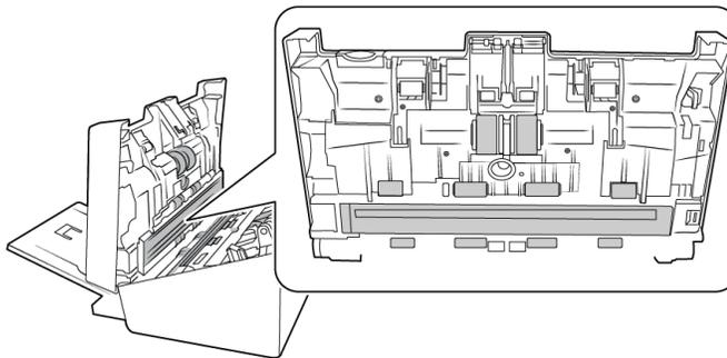
5. Com um cotonete limpo e seco, limpe os sensores de detecção de alimentação dupla.
