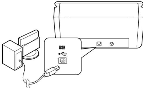
Se a tomada não se conectar facilmente, certifique-se de estar conectando-a corretamente. Não force a tomada em nenhuma das conexões.
