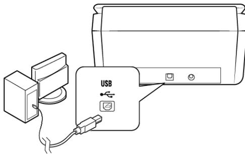
Si el conector no entra con facilidad, asegúrese de estar conectándolo correctamente. No fuerce el conector para realizar la conexión.
