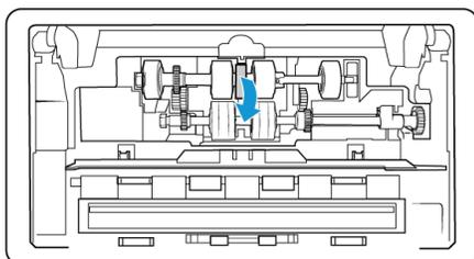
11. Levante la tapa del rodillo y empújela con cuidado para colocarla en su lugar. Asegúrese de que todo esté correctamente alineado y que la tapa esté completamente cerrada. Si la tapa no está completamente cerrada, se romperá durante el escaneo y el escáner se estropeará.
