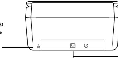
Utilice esta ranura para conectar al escáner el cable USB incluido. No utilice otro tipo de cables USB. No intente instalar un candado de seguridad en este puerto.
