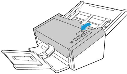
2. Busque la tapa de los rodillos en el cuerpo del escáner.
