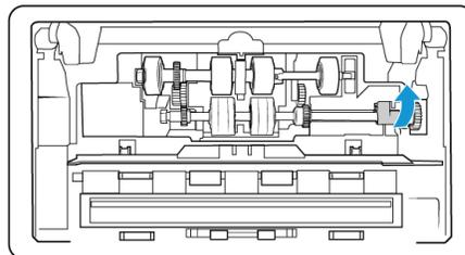
10. Para el DM6440 (Número de pieza del escáner 85-0339-### y superiores) únicamente, rote la banda hacia abajo para que quede en su lugar nuevamente. La cubierta no se cerrará si la banda está en la posición incorrecta.
