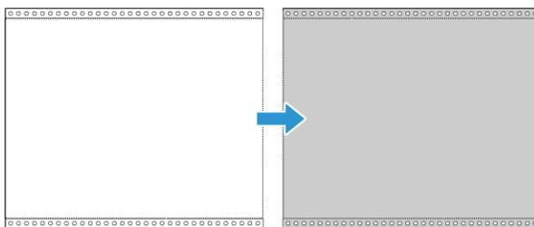
No coloque una pila de papel continuo en la bandeja de entrada, ya que este papel podría rasgarse cuando el rodillo de separación intente separar la página actual del resto de la pila. Si desea escanear un documento largo de papel de matriz de puntos, pruebe a colocar la pila de documentos en la mesa, detrás de la bandeja de entrada. Cierre la extensión de la bandeja de entrada y coloque la primera hoja en ella.
