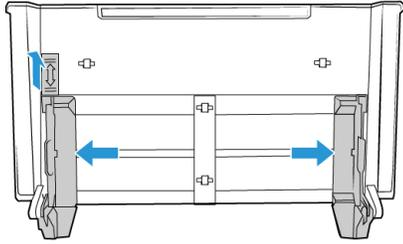
3. Levante las guías del papel y extienda las bandejas de entrada y salida.
