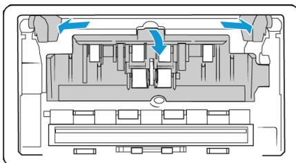
**Nota:** Si las guías del papel se encuentran delante la tapa del rodillo al abrirla, se soltarán automáticamente del cuerpo del escáner. Si esto sucede, siga las instrucciones de la página 6-4 para restablecer las guías del escáner.
