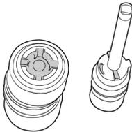
9. Inserte el extremo redondeado del rodillo en la ranura del escáner. Baje con cuidado el rodillo hacia el interior del escáner. Asegúrese de que la ranura del lado derecho de la barra esté alineada de forma que se deslice en su lugar en la forma de U del soporte.
