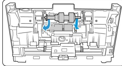
10. Levante la tapa del rodillo y empújela con cuidado para colocarla en su lugar. Asegúrese de que todo esté correctamente alineado y que la tapa esté completamente cerrada. Si la tapa no está completamente cerrada, se romperá durante el escaneo y el escáner se estropeará.
