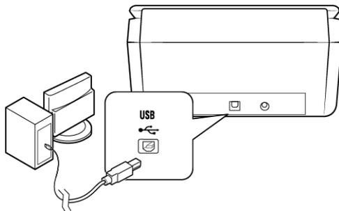
Wenn der Stecker nicht ohne Widerstand eingesteckt werden kann, vergewissern Sie sich, dass Sie ihn korrekt und in den richtigen Anschluss stecken. Drücken Sie den Stecker nicht gewaltsam in den Anschluss.
