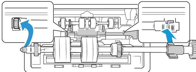
9. Drehen Sie den Sicherungsriegel in den Schlitz im Scanner. Drücken Sie den Hebel, bis er einrastet und die Walze im Scanner verriegelt.
