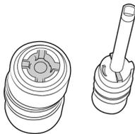
9. Setzen Sie das runde Ende der Walze in die Aussparung im Scanner ein. Führen Sie die Walze vorsichtig in den Scanner ein. Vergewissern Sie sich, dass die Rille rechts an der Aufhängung so ausgerichtet ist, dass sie in die U-Form der Klammer passt.
