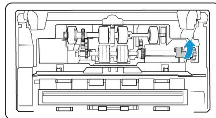
10. Nur beim DM6440 (Scanner-Teilenummer 85-0339-### und höher) den Riemen wieder zurück in seine Ausgangsposition drehen. Die Abdeckung lässt sich nicht schließen, wenn sich der Riemen in der falschen Position befindet.
