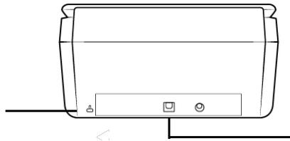
Schließen Sie über diesen Steckplatz ausschließlich das im Lieferumfang enthaltene USB-Kabel an den Scanner an. Verwenden Sie keine andere Art von USB-Kabel. Versuchen Sie nicht, ein Sicherheitsschloss mit diesem Anschluss zu verbinden.
