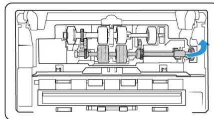
7. Entnehmen Sie die neue Walze aus der Verpackung. Entfernen Sie vor dem Befestigen sämtlichen Staub von der Walze.
