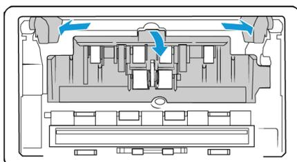
**Hinweis:** Wenn die Papierführungen sich beim Öffnen vor dem Walzendeckel befinden, werden sie automatisch aus dem Scannergehäuse freigegeben. Ist dies der Fall, folgen Sie den Anweisungen auf Seite 6-4 zum Zurücksetzen der Führungen im Scanner.
