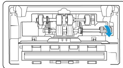
6. Winkeln Sie die Walze nach oben an, und entnehmen Sie sie aus dem Scanner. Entsorgen Sie sie dann, da sie nicht repariert werden kann.
