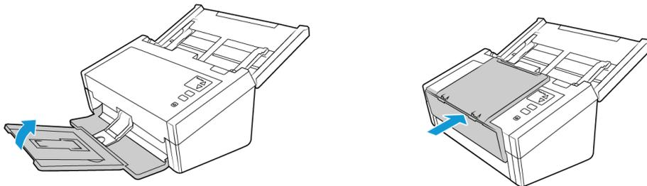
4. Klappen Sie die Papierführungen ein, sodass sie flach am Vorlagenfach anliegen.
