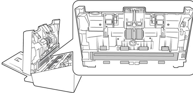
5. Entfernen Sie mit einem sauberen, trocken Baumwolltuch sämtlichen Staub an den Erkennungssensoren für die doppelte Vorlagenzufuhr.
