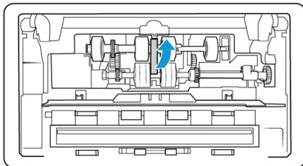
5. Die untere Walze ist mit einem Sicherungsriegel gesichert, der zum Verriegeln und Entriegeln gedreht werden kann. Drehen Sie den Sicherungsriegel zum Entriegeln so lange, bis der kleine Sicherungsflansch vollständig frei liegt.
