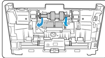
10. Heben Sie den Walzendeckel, und drücken Sie ihn vorsichtig zu, Vergewissern Sie sich, dass alles richtig ausgerichtet und der Deckel vollständig geschlossen ist. Wenn der Deckel nicht vollständig geschlossen ist, wird er beim Scannen brechen und den Scanner beschädigen.
