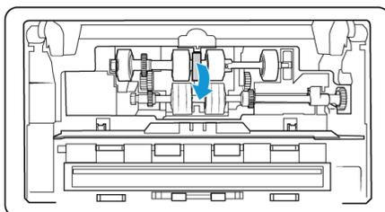
11. Heben Sie den Walzendeckel, und drücken Sie ihn vorsichtig zu, Vergewissern Sie sich, dass alles richtig ausgerichtet und der Deckel vollständig geschlossen ist. Wenn der Deckel nicht vollständig geschlossen ist, wird er beim Scannen brechen und den Scanner beschädigen.
