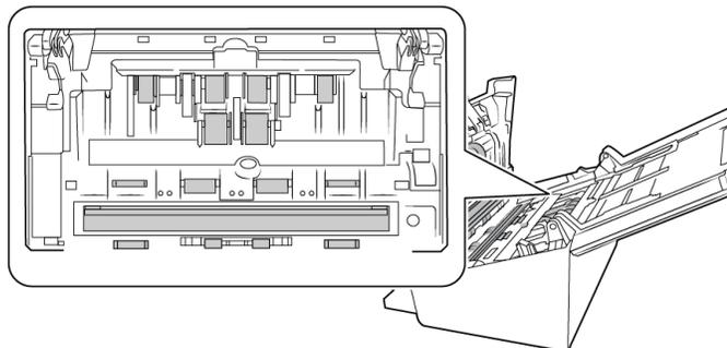
4. Wischen Sie die Walzen und das Glas an der Unterseite der Klappe des automatischen Vorlageneinzugs sauber. Drehen Sie die Walzen, um die gesamte Oberfläche zu reinigen.
