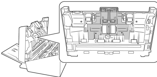
3. Drücken Sie auf die Seiten der Walzenabdeckung, und ziehen Sie sie nach unten, um Zugang zu der Walze zu haben.
