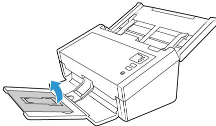
4. Legen Sie die Vorlagen *mit der zu scannenden Seite nach unten* und mit der Oberkante zuerst in den automatischen Vorlageneinzug ein.
