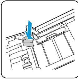
3. Sie können den Scanner schließen, wenn beide Papierführungen ordnungsgemäß im Scanner befestigt sind.
