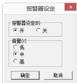
蜂鳴器設定 **[Buzzer Setting]**— 按一下 [ 開啟 ][On] 或 [ 關閉 ] [Off] 以設定掃描器警示音效。掃描器警示音效包括多頁進紙偵測、卡紙錯誤、燈泡錯誤等 ...
