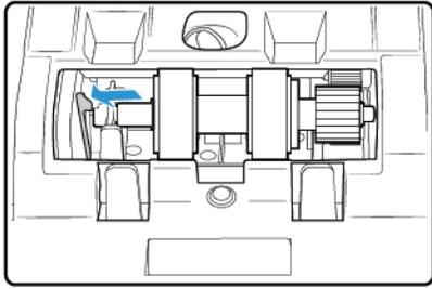
3. Soulevez doucement la barre du rouleau du côté gauche, puis retirez par la gauche le rouleau du scanneur, en le dégageant des engrenages situés sur le côté droit du compartiment.
