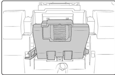
6. Soulevez légèrement le module de rouleaux dans le scanneur, puis faites pivoter le bras de verrouillage vers le haut pour le bloquer. Assurez-vous que le module de rouleaux soit correctement mis en place lorsque vous fermez le scanneur.
