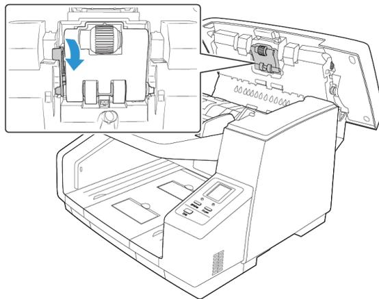
2. Retirez soigneusement le module de rouleaux du scanner. Jetez le module de rouleaux, qui ne peut être ni réparé, ni réutilisé.
