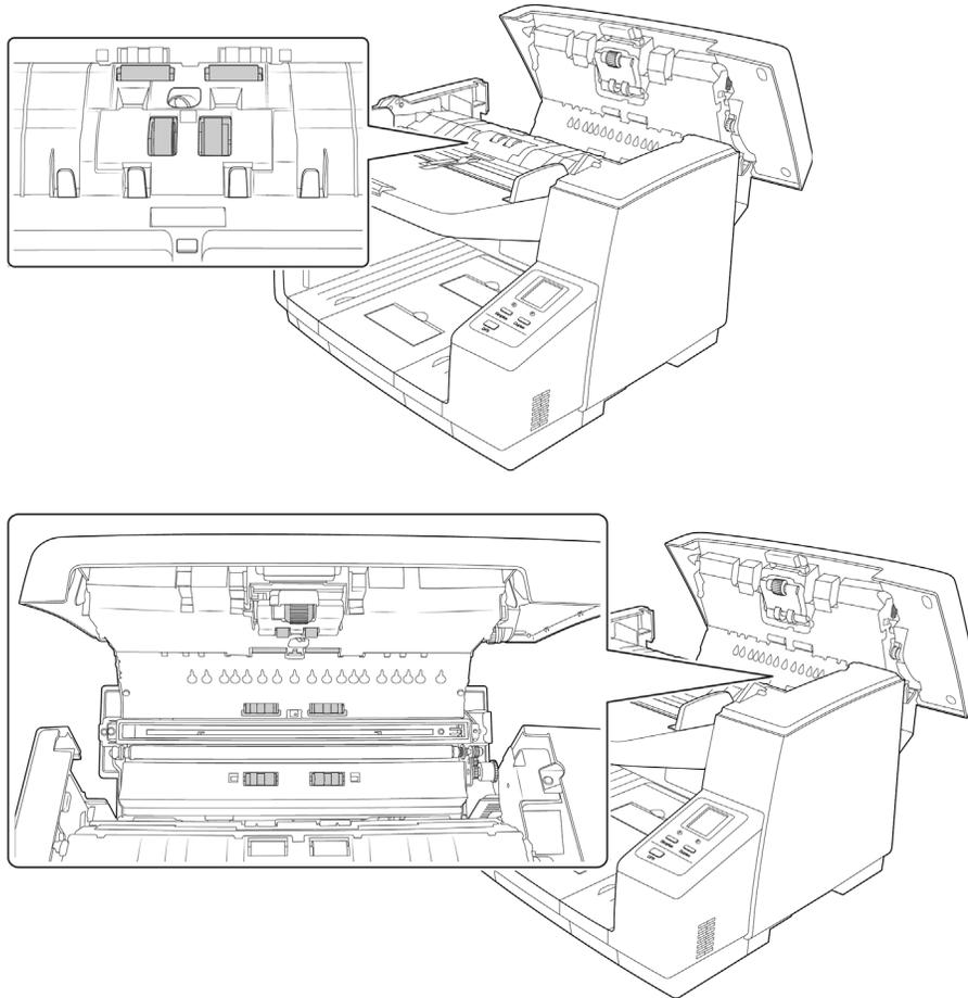
**Remarque :** Soyez prudent en nettoyant les rouleaux. Tous les rouleaux, à l'exception des rouleaux libres, sont conçus pour tourner dans un seul sens. Ne Forcez Pas le rouleau à pivoter dans le sens inverse. Une rotation forcée des rouleaux peut les endommager et entraîner des erreurs d'alimentation.
