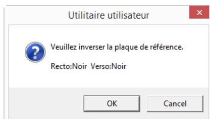
**Remarque :** Ne mettez pas la feuille de réglage de l'ombrage dans le scanner. Le scanner n'utilise pas de feuille de réglage de l'ombrage pour le réglage sur fond noir.
