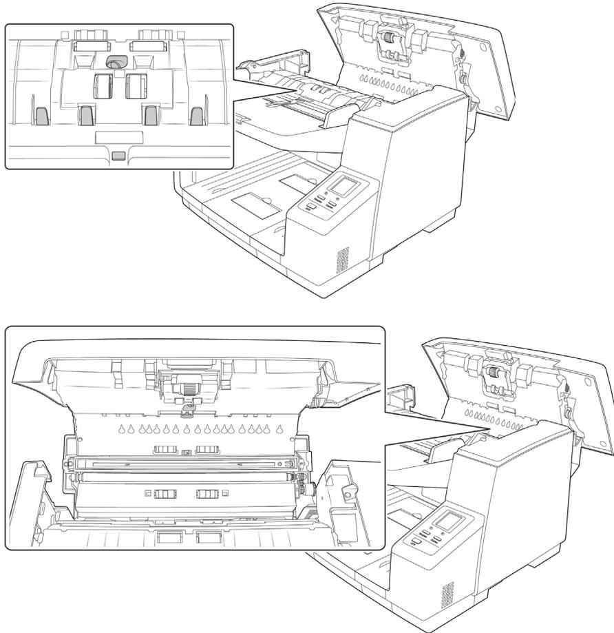
3. Dirigez l'extrémité de la souffleuse vers le capteur et pressez-la pour envoyer un jet d'air sur la tête du capteur de manière à enlever la poussière.
