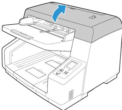
2. L'illustration suivante indique l'emplacement de la vitre et des plaques de fond, en haut et en bas du scanner. Les plaques de fond sont des rouleaux que vous pouvez faire pivoter pour passer du noir au blanc. Lorsque vous nettoyez les plaques de fond, faites pivoter les barres pour nettoyer toute la surface.
