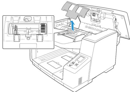
3. Alignez l'extrémité de l'engrenage en plastique située sur le côté droit du rouleau avec les engrenages du compartiment de rouleau. Veillez à ce que le côté plat du bout des rouleaux soit correctement aligné avec la fente du scanner.
