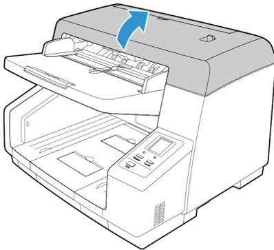
Une fois les rouleaux remplacés, fermez soigneusement le scanneur en appuyant sur les deux côtés du couvercle jusqu'à ce qu'un déclic se produise. Ne claquez pas le couvercle.
