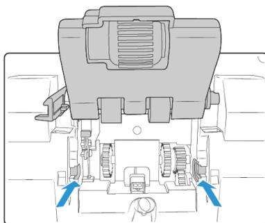
5. Insérez le côté droit du module de rouleaux dans le scanneur, puis inclinez le côté gauche du module de rouleaux pour l'insérer dans le scanneur. Veillez à ce que les engrenages s'engagent correctement lors de l'insertion du module de rouleaux dans le scanneur.
