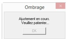
**Remarque :** N'interrompez pas le réglage de l'ombrage une fois qu'il a commencé. Après avoir avalé la feuille de réglage de l'ombrage, le scanner s'arrête plusieurs fois. C'est parfaitement normal. Le réglage de l'ombrage à l'aide de la feuille prendra environ 5 minutes.
