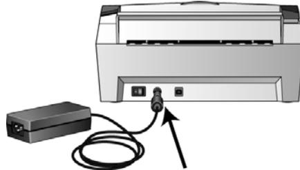
**NOTA:** utilizzare solo l'alimentatore accluso allo scanner (HiTron HEG42-240200-7L). L'uso di un altro tipo di alimentatore può danneggiare lo scanner e invalidarne la garanzia.
