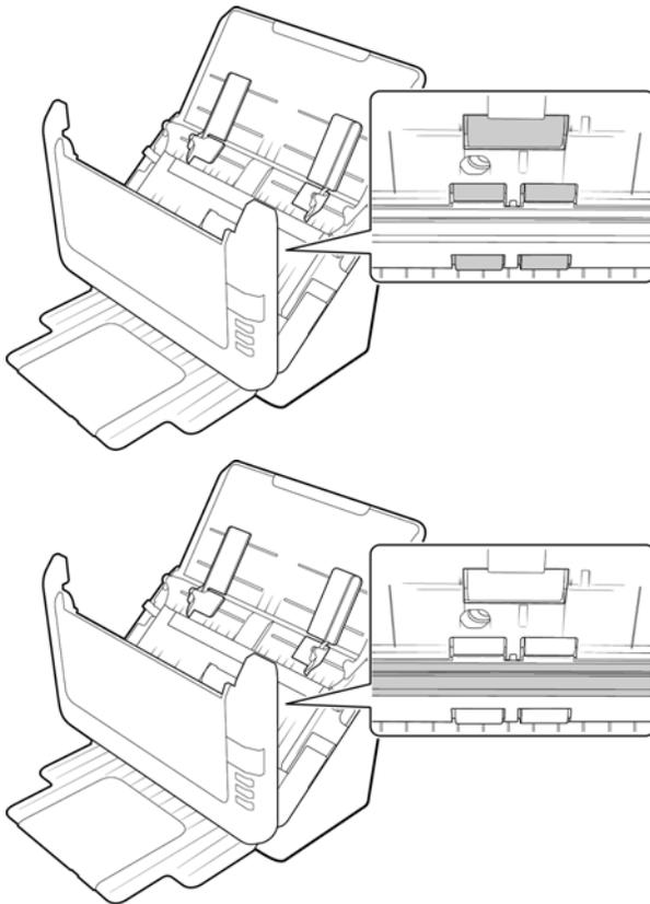
4. Pulire il pad dell'ADF dall'alto verso il basso. Prestare attenzione a non fare impigliare il panno nelle molle ai lati del pad. Strofinare i rulli liberi da lato a lato. Ruotare i rulli verso il basso per pulire l'intera superficie di ciascun rullo. Pulire il piano fisso e la piastra posteriore nella parte inferiore dello sportello di fuoriuscita.
