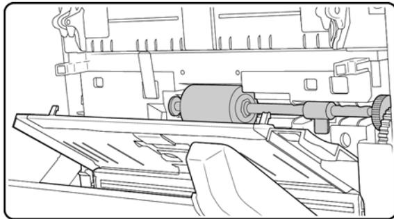
4. Il rullo è trattenuto in posizione da una linguetta di blocco che ruota per bloccarlo e sbloccarlo. Per sbloccare la linguetta, ruotarla verso l'alto fino a quando la piccola flangia di blocco è completamente libera.
