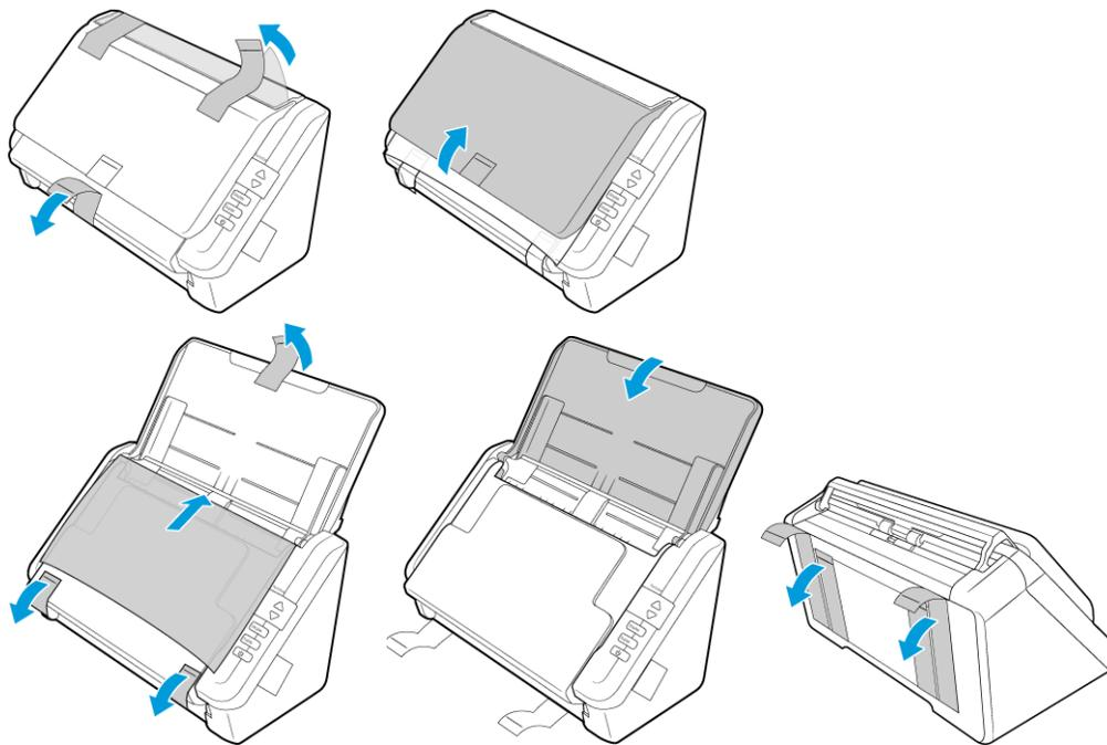
3. Sollevare il cassetto di input dallo scanner. Sollevare il cassetto di output dal corpo dello scanner. Quando sarà completamente abbassato scatterà in posizione.
