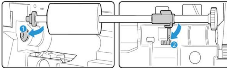
9. Ruotare la linguetta di blocco verso il basso in modo che la flangia di blocco si agganci nel fermo corrispondente. Non forzare la linguetta di blocco in posizione. Se non ruota liberamente per entrare in posizione, verificare che la flangia sia adeguatamente inserita nel relativo fermo.
