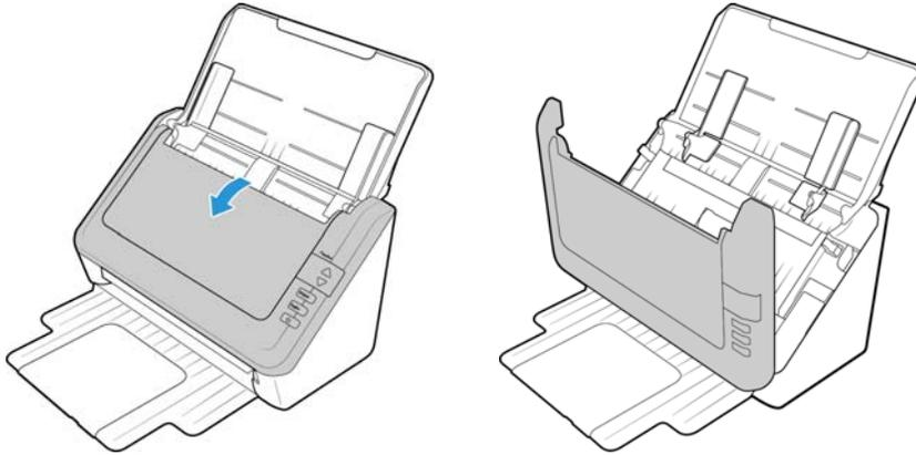
3. Strofinare i rulli di alimentazione e di separazione da lato a lato. Ruotare i rulli verso il basso per pulire l'intera superficie di ciascun rullo. Pulire il piano fisso e la piastra posteriore nel corpo dello scanner.
