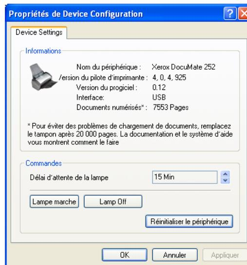
Votre scanner est doté d'une fonction de veille intégrée, qui est configurée pour se mettre hors tension après 15 minutes d'inactivité. Vous pouvez modifier le délai avant la coupure de courant du scanner de 10 minutes à dix heures maximum.
