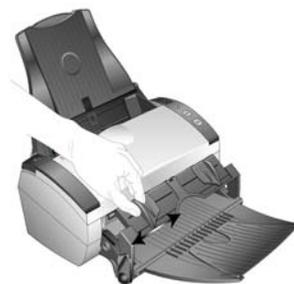
2. Collocare tra le guide della carta sul cassetto di alimentazione anteriore un solo elemento con il lato da scansionare *rivolto verso l'alto*, con il margine superiore rivolto verso lo scanner.
