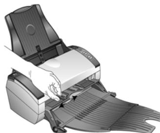
2. Collocare tra le guide della carta sul cassetto di alimentazione anteriore un solo elemento con il lato da scansionare *rivolto verso l'alto*, con il margine superiore rivolto verso lo scanner.
