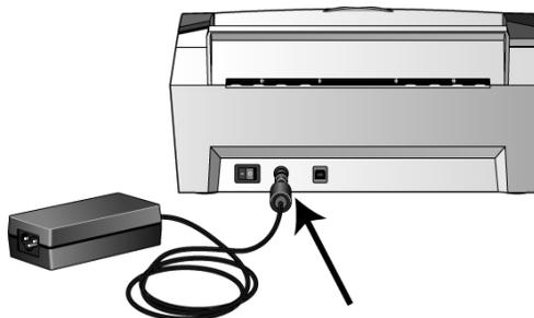
**NOTA:** utilizzare solo l'alimentatore (HEG42-240200-7L di HiTron) accluso allo scanner. L'uso di un altro tipo di alimentatore può danneggiare lo scanner e ne invalida la garanzia.
