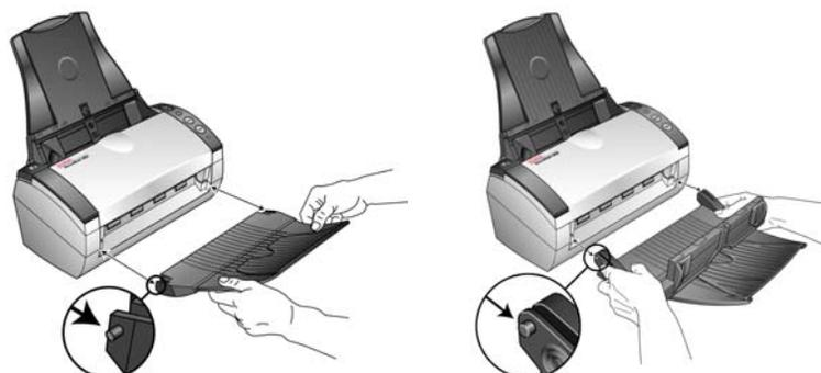
7. Aprire l'estensione sul cassetto di output capovolgendola in modo da estenderla completamente.
