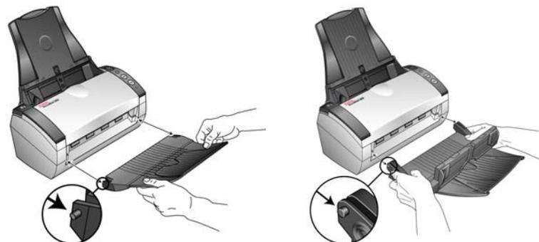
7. Abra la extensión de la bandeja de salida de modo que quede completamente extendida.
