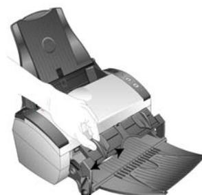
2. Coloque un solo elemento *hacia arriba*, con la parte superior apuntando al escáner, entre las guías del papel en la bandeja de alimentación frontal.
