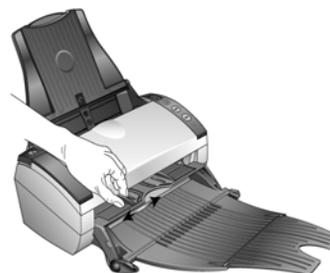
2. Coloque un solo elemento *hacia arriba*, con la parte superior apuntando al escáner, entre las guías del papel en la bandeja de alimentación frontal.
