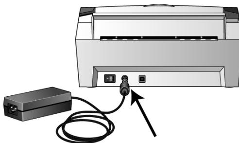
**NOTA:** Utilice solamente el suministro de alimentación incluido con su escáner (HEG42-240200-7L fabricado por HiTron). La conexión de cualquier otro tipo de suministro de alimentación puede dañar el escáner e invalidará su garantía.
