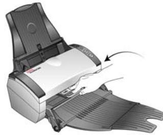
4. Der Scanner zieht die Vorlage über den vorderen Vorlageneinzug ein, und der Vorlageneinzug kehrt in die Ausgangsposition zurück.
