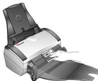
3. Drücken Sie den Vorlageneinzug nach unten, und führen Sie die Vorlage in den Scanner ein.
