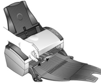
2. Legen Sie eine einzelne Vorlage *mit der zu scannenden Seite nach oben* und mit der Oberkante zuerst zwischen den Papierführungen am vorderen Vorlageneinzug ein.
