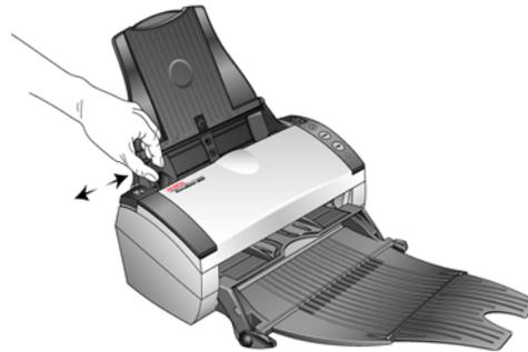
2. Legen Sie die Vorlagen *mit der zu scannenden Seite nach unten* und mit der Oberkante zuerst in den automatischen Vorlageneinzug ein.
