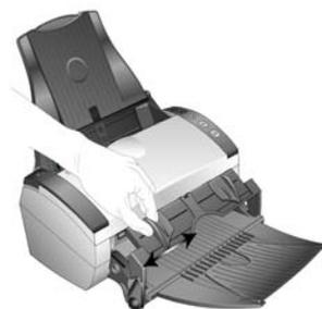
2. Legen Sie eine einzelne Vorlage *mit der zu scannenden Seite nach oben* und mit der Oberkante zuerst zwischen den Papierführungen am vorderen Vorlageneinzug ein.
