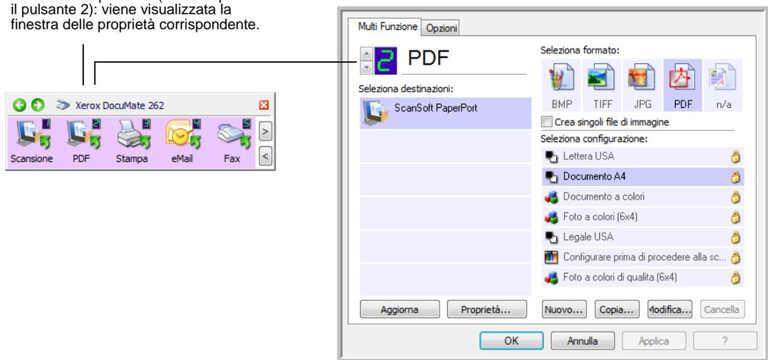
La finestra delle proprietà di One Touch viene visualizzata anche quando si tiene premuto e si rilascia il pulsante Simplex o Duplex sullo scanner.
