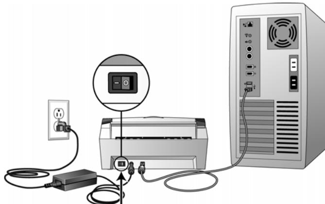
La spia dello stato inizia a lampeggiare per indicare che lo scanner è alimentato.
