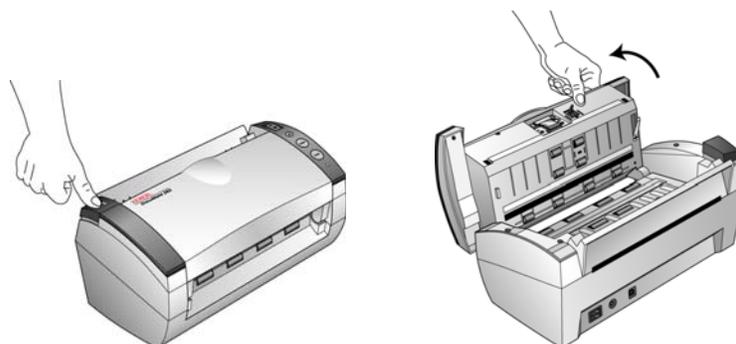
3. Strofinare il rullo di alimentazione da lato a lato. Ruotare il rullo per pulirne tutta la superficie.
