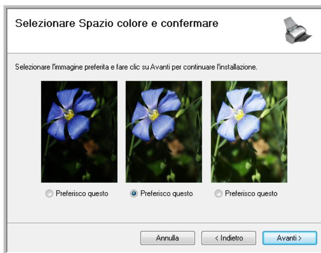
L'impostazione Spazio colore imposta il valore gamma per lo scanner, per una visualizzazione corretta delle immagini scansionate. Il valore gamma consente di controllare la luminosità dei mezzitoni dei colori. Tale impostazione può essere modificata successivamente durante la scansione.
