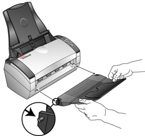
6. Aprire l'estensione sul cassetto di output capovolgendola in modo da estenderla completamente.
