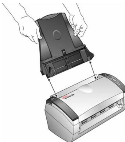
5. Setzen Sie die Stifte auf beiden Seiten des Ausgabefachs in die entsprechenden Aufnahmen am Scanner ein.
