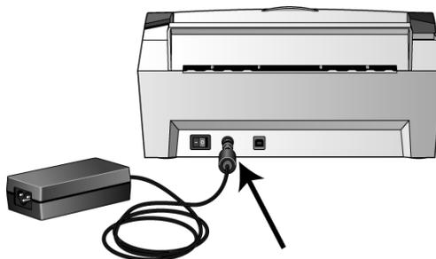
**HINWEIS:** Verwenden Sie nur das Netzteil (HEG42-240200-7L, hergestellt von HiTron), das im Lieferumfang Ihres Scanners enthalten ist. Andere Netzteile können den Scanner beschädigen und führen zum Erlöschen der Garantie.
