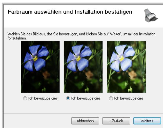
Mit der Farbraumeinstellung wird der Gamma-Wert für den Scanner festgelegt, mit dem gescannte Vorlagen für die Anzeige auf dem Bildschirm optimiert werden. Mit dem Gamma-Wert regulieren Sie die Helligkeit der mittleren Farbtöne. Diese Einstellung kann später während des Scannens angepasst werden.
