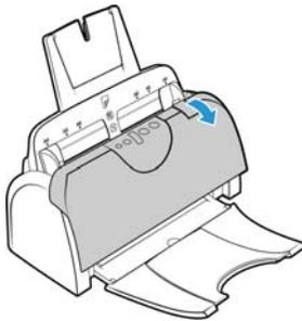
2. Retire a bandeja de entrada de papel. O rolamento fica localizado no corpo do scanner, atrás da bandeja de entrada.
