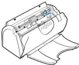
5. Em seguida, estabeleça o ângulo do rolamento para a parte dianteira do scanner até que ele se solte do compartimento e retire-o do corpo do scanner.
