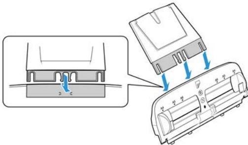
4. Abra a tampa do ADF e remova cuidadosamente quaisquer pedaços de espuma que possam ter entrado dentro dele. Deixe a tampa aberta para que você possa inserir a bandeja de entrada.
