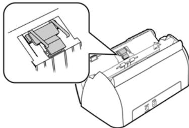
3. Aperte os grampos plásticos que seguram a montagem de almofada no lugar, levante a almofada e retire-a. Inverta o procedimento para colocar a nova almofada nas aberturas.
