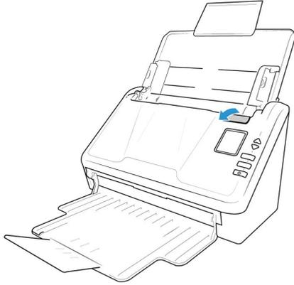
2. Lokalisieren Sie die Abdeckung der Friktionswalze im Gehäuse des Scanners.
