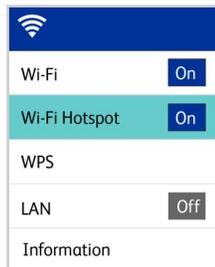
4. Navigieren Sie zu **Informationen** und wählen Sie sie aus, wählen Sie dann **Wi-Fi** und drücken Sie dann die Abwärtstaste, um die Hotspot-IP und SSID anzuzeigen.
