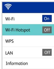
3. Drücken Sie die **Duplex**-Taste, um den Wi-Fi-Hotspot einzuschalten (wenn Sie die Duplex-Taste erneut drücken, wird der Wi-Fi-Hotspot ausgeschaltet).
