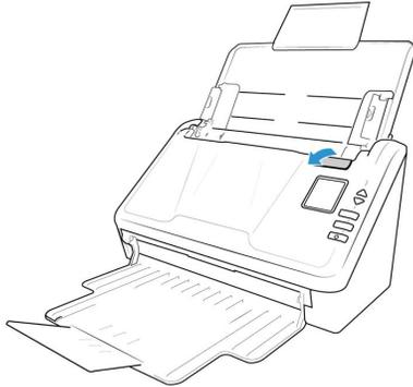
2. Halten Sie die Tasten **Simplex** und **Duplex** länger als zwei Sekunden gedrückt, um das LCD-Scannermenü aufzurufen.
